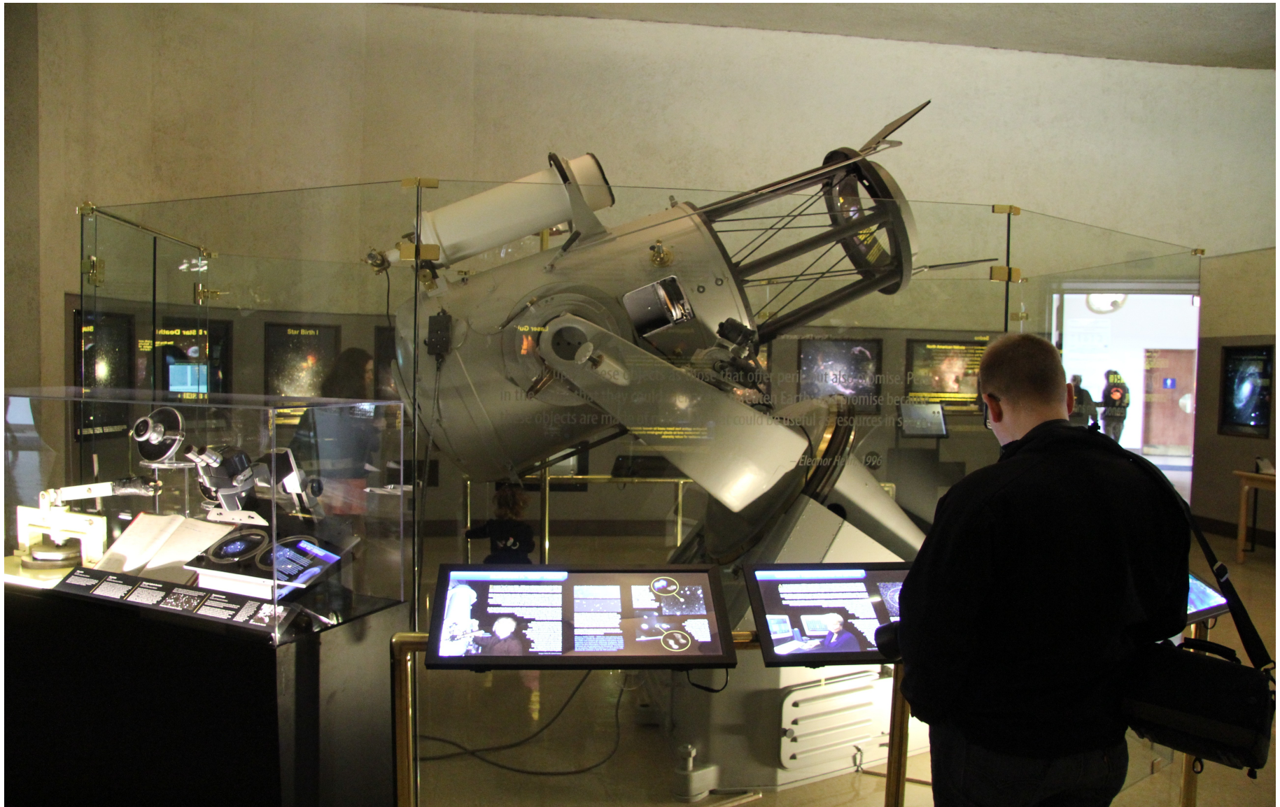
Museoitu 18 tuuman (0.46-m) Schmidt kaukoputki Kaukoputki ollut käytössä 1936 - ~1990
