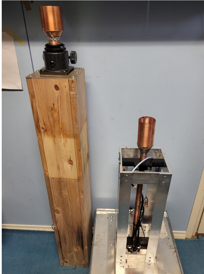
6.7GHz Metanolimaser vastaanotin (vas.) 10GHz RX/TX-transvertteri (oik.)
